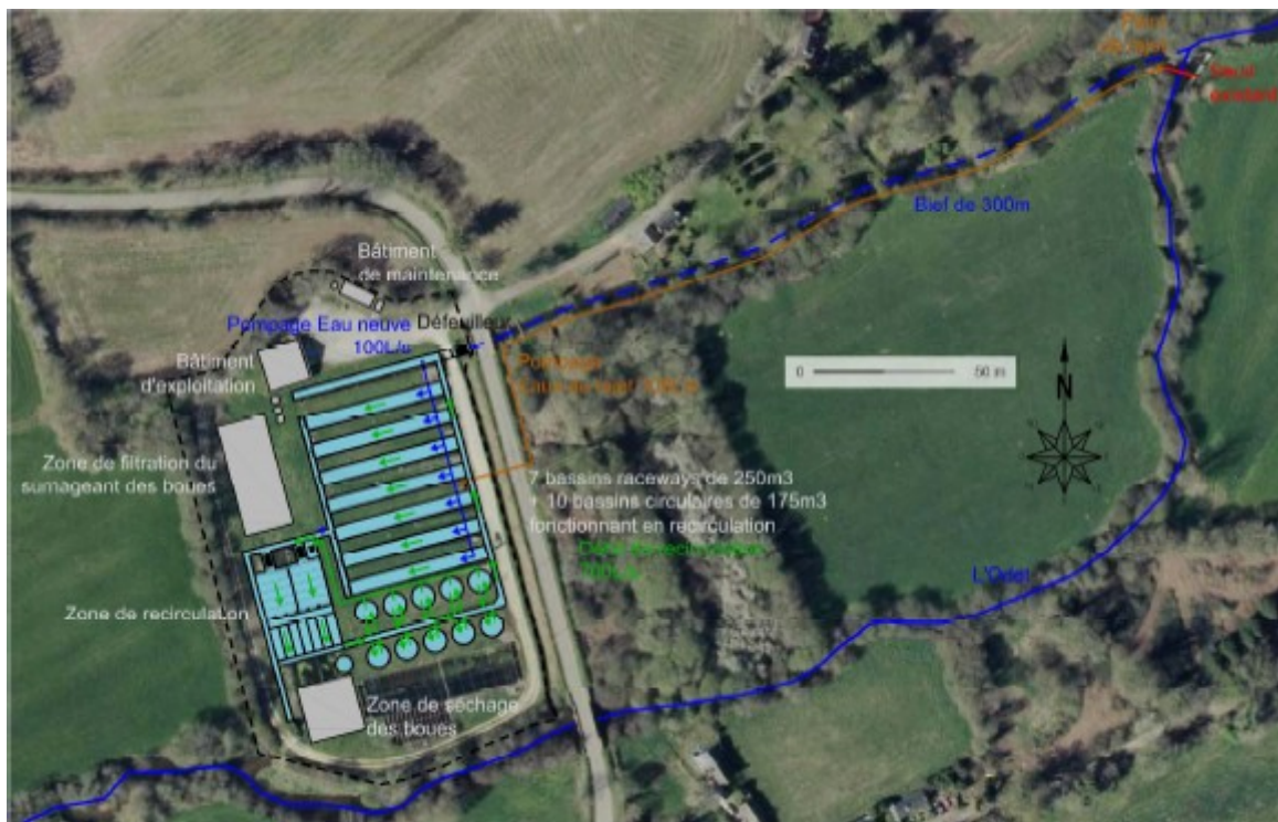
Extrait du dossier – Schéma de la future pisciculture fonctionnant en recirculation en période de basses eaux
